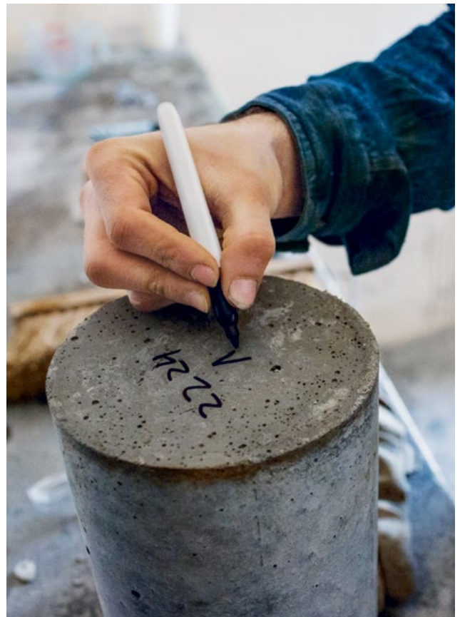
Échantillons destinés à tester la résistance mécanique du béton.
