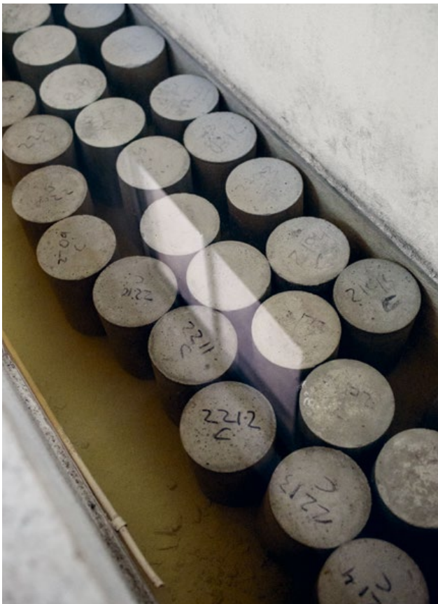
Échantillons destinés à tester la résistance mécanique du béton.
